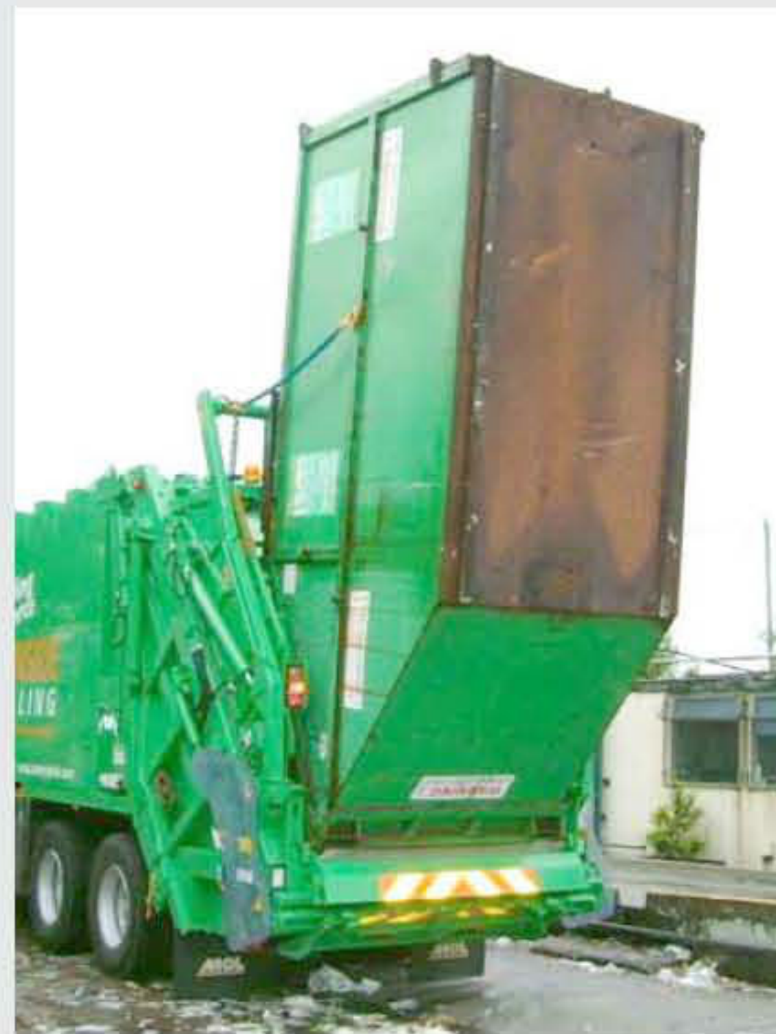
Lifting with REL arms: 8 cu yd - 11,5 cu yd - 13 cu yd - 14 cu yd - 16 cu yd.
