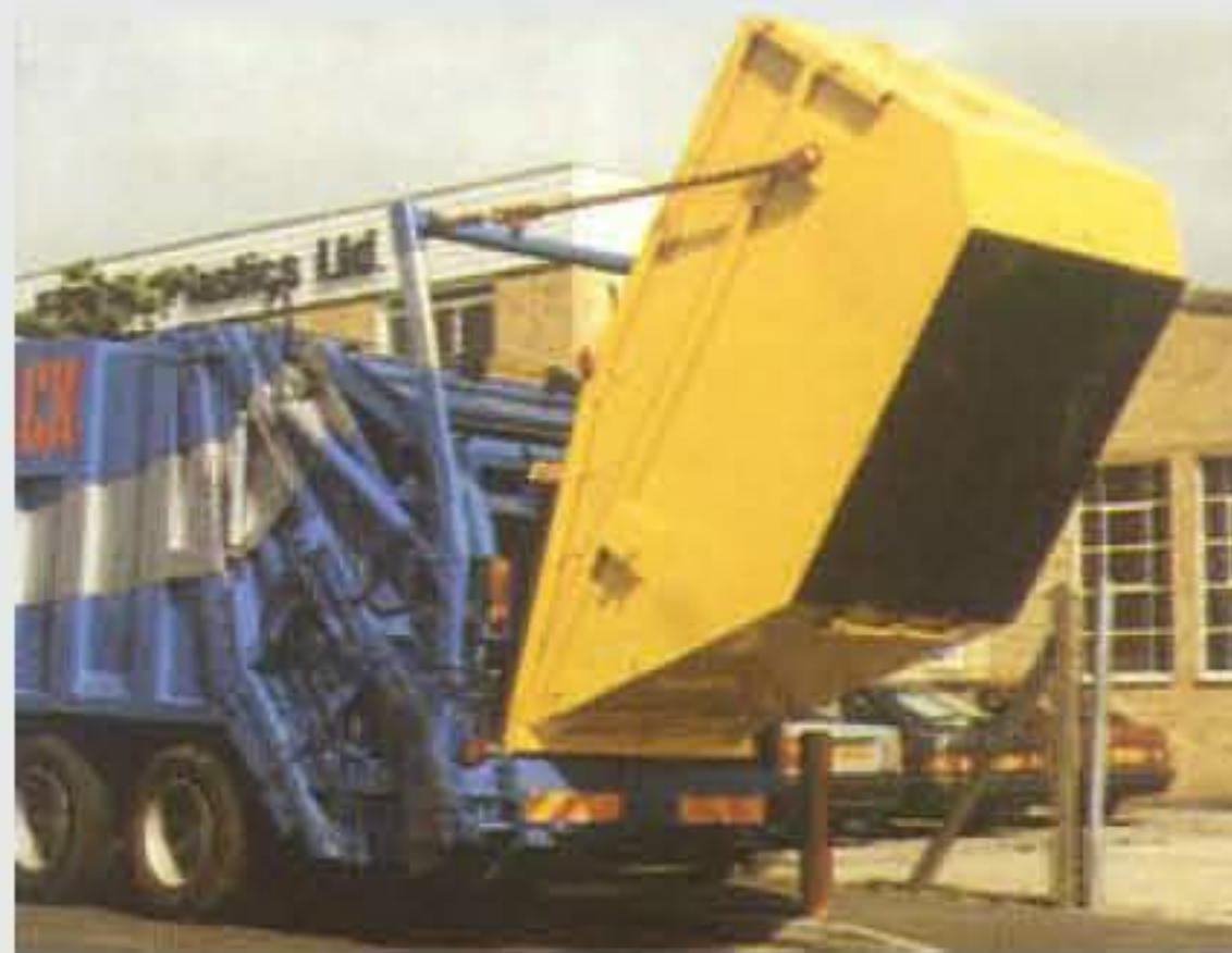
Lifting with REL arms: 8 cu yd - 11,5 cu yd - 13 cu yd - 14 cu yd - 16 cu yd.
