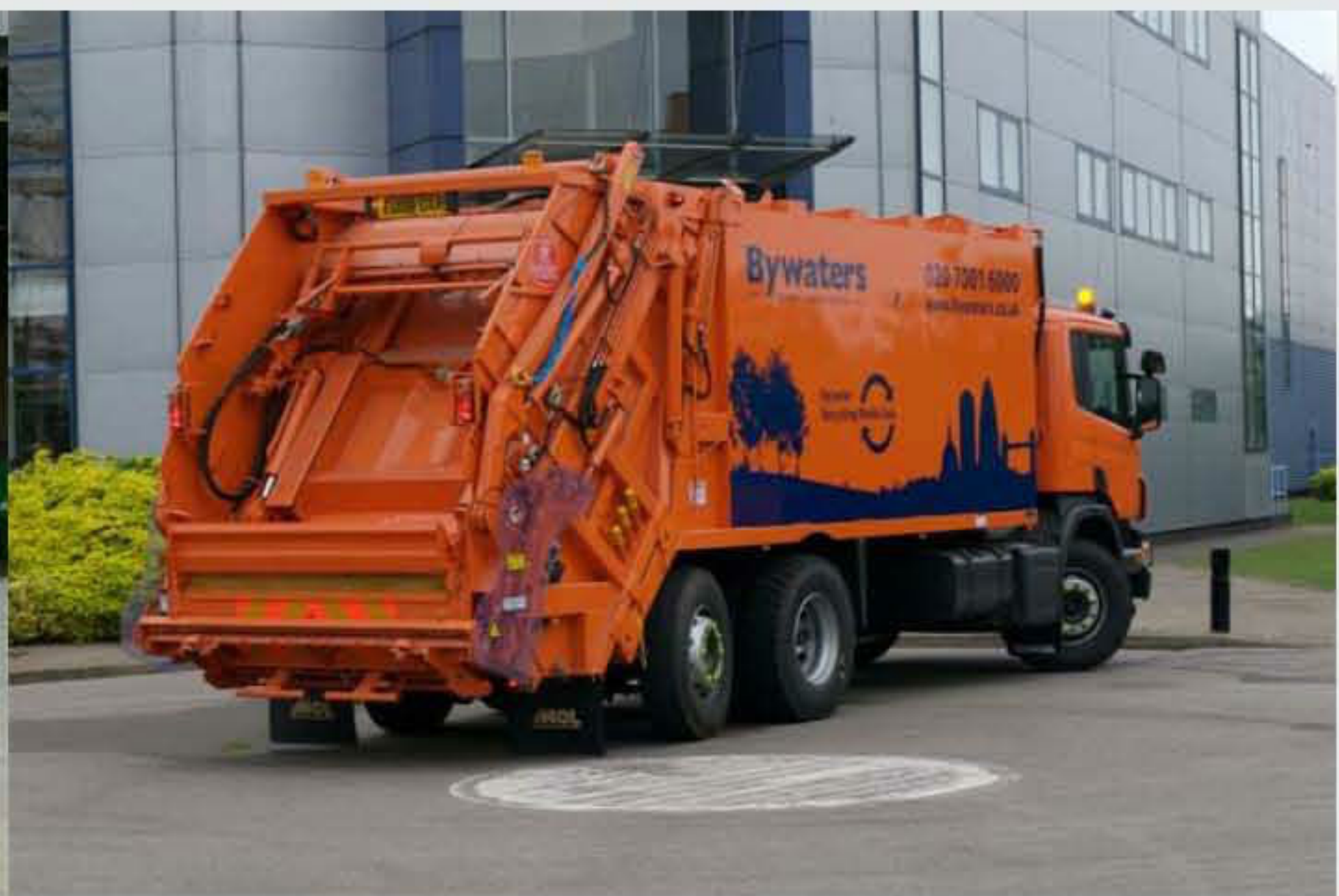
Lifting with REL arms: 8 cu yd - 11,5 cu yd - 13 cu yd - 14 cu yd - 16 cu yd.
